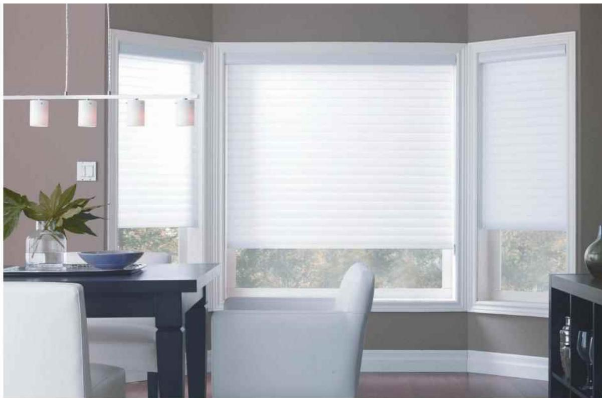
Управление шторой МИРАЖ осуществляется при помощи шнура-петли. Полотно ткани можно опускать и поднимать как у обычной рулонной шторы, а в самой нижней точке можно изменять наклон тканевых ламелей и регулировать оптимальное освещение в помещении.
